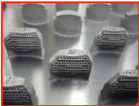
図 4-1 造形されたインプラントと骨模型上でのインプラントの適合性確認。
