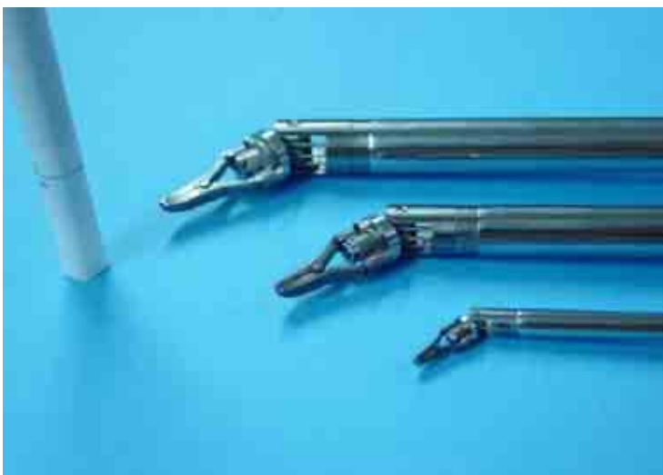
Fig. 1. マスタ・スレーブ一体型ロボット鉗子の先端部分.
