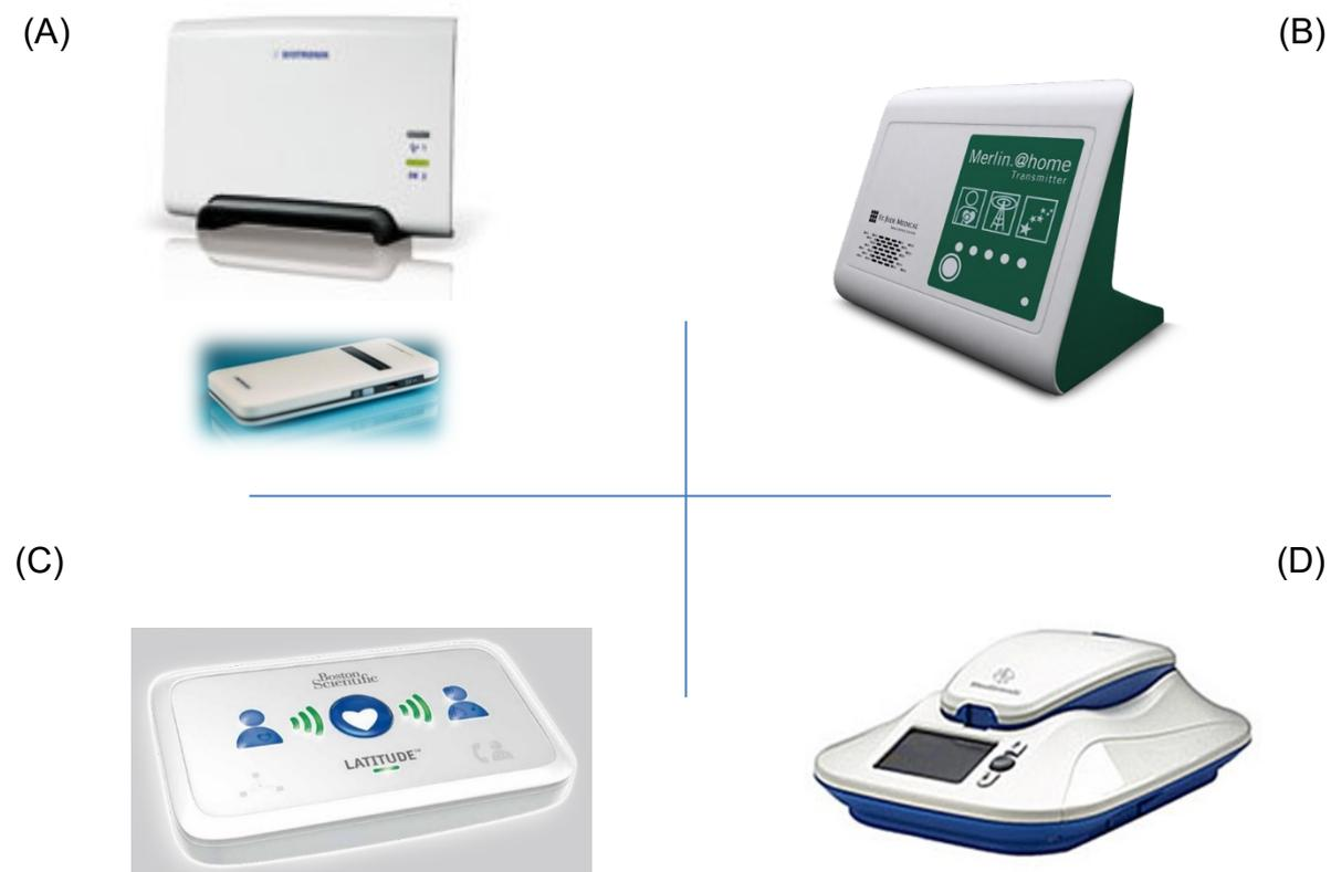
図2 モニタリング中継器例
